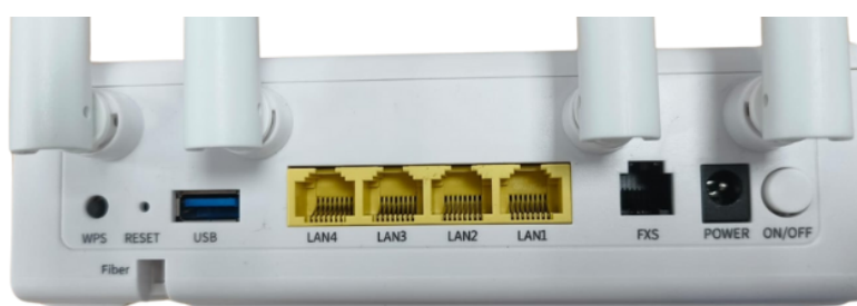
Imagen 6. Identificación de Botón WPS en ONU Mesh
