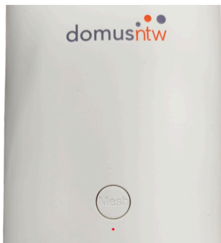
Imagen 7. Identificación de Botón Mesh en Satélite Mesh
